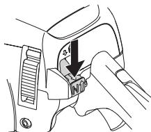
Остановка двигателя осуществляется нажатием на выключатель запуска/остановки.
