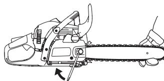
При установке новой цепи следует часто проверять ее натяжение , пока цепь не приработается. Регулярно проверяйте натяжение цепи. Регулярно проверяйте натяжение цепи. Правильно натянутая цепь обеспечивает высокое качество пиления и долгое служит.
