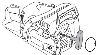
В некоторых глушителях предусмотрен специальный искрогаситель. Если ваша машина оборудована таким глушителем, сетку фильтра следует чистить раз в неделю. Наилучшие пользуйтесь стальной щеткой. Забитая решетка приводит к работе с горячим двигателем, что дает серьезные повреждения двигателя.
