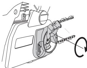
При установки новой цепи следует часто проверять ее натяжение , пока цепь не приработается. Регулярно проверяйте натяжение цепи. Регулярно проверяйте натяжение цепи. Правильно натянутая цепь обеспечивает высокое качество пиления и дольше служит.
