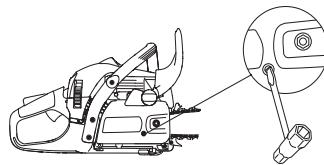
Цепь считается натянутой правильно, если она свободно проворачивается рукой. После этого, удерживая носок пильного полотна в вверхнем положении, затяните гайки крепления пильного полотна универсальным ключом.
