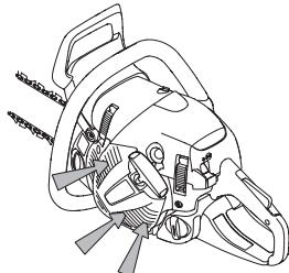
**ВАЖНО!** Для осуществления метода центробежной очистки нужно постоянно выполнять техническое обслуживание и уход за системой. Необходимо чистить воздухозаборник стартера, лопасти вентилятора на маховике, пространство вокруг маховика, входного коллектора и карбюратора.
