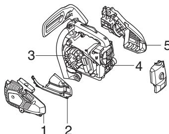
Производите очистку системы охлаждения щеткой раз в неделю или чаще, если этого требуют условия работы. Загрязненная или засоренная система охлаждения может привести к перегреву машины и вызвать повреждение поршня и цилиндра.
