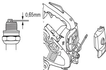
Обратите внимание! Всегда используйте только указанный тип свечи! Применение несоответствующей модели может привести к серьезным повреждениям поршня/цилиндра. Следите за тем, чтобы свеча была оснащена т.н. изоляцией радиопомех.
