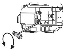
Когда топливо полностью израсходовано, масляный бак также обычно бывает почти пуст. Обязательно заполняйте масляный бак при каждой заправке пилы.
