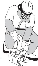
Нажмите регулятор, как только заработает двигатель (это можно определить по характерному звуку). С силой вытягивайте шнур, пока не запустится двигатель. Когда двигатель запустится, дайте полный газ и отпустите рычаг дроссельной заслонки и
