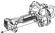
Установите пильное полотно на специально предназначенные болты. Установите полотно в самое заднее положение. Оденьте цепь на ведущую звездочку и вставьте ее хвостовики в паз пильного полотна. Начинайте с верхней стороны пильного полотна.
