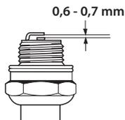
**ВНИМАНИЕ!** Всегда используйте только указанный тип свечи! Применение несоответствующей модели может привести к серьезным повреждениям поршня/цилиндра. Следите за тем, чтобы свеча была оснащена т.н. изоляцией радиопомех.
