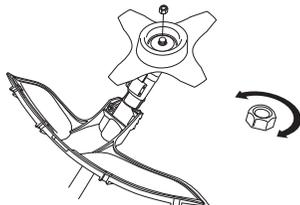
При сборке надо затягивать гайку против направления вращения режущего оборудования. При разборке надо отвинчивать гайку в направлении вращения режущего оборудования. (ЗАМЕЧАНИЕ! Гайка имеет левостороннюю резьбу.) Затяните гайку торцевым гаечным ключом.
