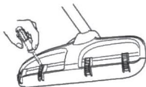
Установка щитка для лезвия, лезвия для травы и ножа для травы
