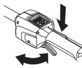
См. указания в разделе **Запуск**. Запустите машину на полную мощность. Отпустите переключатель и удостоверьтесь, что режущее оборудование останавливается и остается неподвижным.
