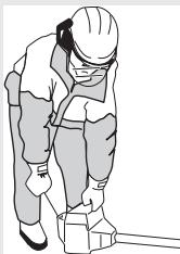
Всегда тяните шнур стартера под прямым углом. Вытягивание стартера не под прямым углом приведет к перетиранию шнура в петле. В результате трения возможен более быстрый износ шнура. Всегда удерживайте ручку стартера при возвращении шнура. Запрещается позволять шнуру произвольно возвращаться из вытянутого положения. Это может привести к заеданию шнура или его износу, а также повреждению узла стартера.
