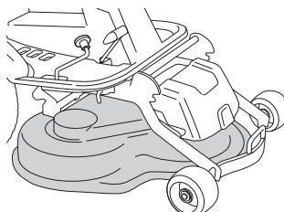
Узел Combi со смонтированной заглушкой Mulching, измельчает скошенную траву в удобрение почвы. Без заглушки Mulching узел работает как с узлом выбрасывания назад.
