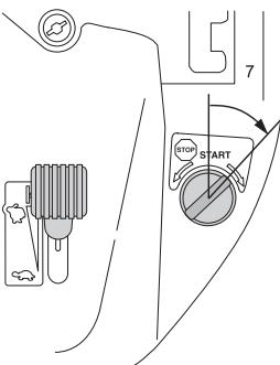
**ВАЖНАЯ ИНФОРМАЦИЯ** Не держите стартер в рабочем положении более 5 секунд. Если двигатель не заводится, подождите примерно 10 секунд перед попыткой повторного запуска.
