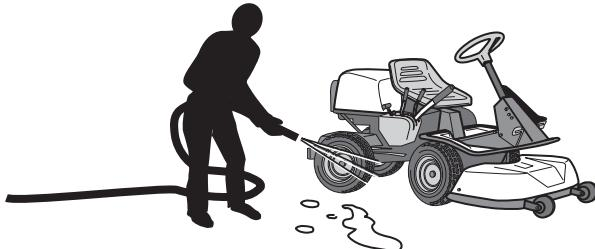
Масляные загрязнения могут быть сняты холодным обезжиривателем. Распылите тонкий слой.
