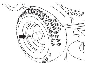
**ВАЖНАЯ ИНФОРМАЦИЯ** Неодинаковое давление в шинах приводит к тому, что стрижка травы будет неровной. Для того чтобы достичь наилучшей производительности, а также избежать повреждения машины, необходимо, чтобы давление в шинах было одинаковым.
