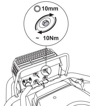
Перепады температур и вибрации могут стать причиной ослабления затяжки винтов. Чтобы момент затяжки винтов был правильным, он должен контролироваться при каждом обслуживании. Момент затяжки должен быть примерно 10 Нм. Никогда не используйте машину с дефектным глушителем.
