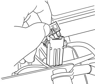
При замене не использовать плавкий предохранитель другого типа.
