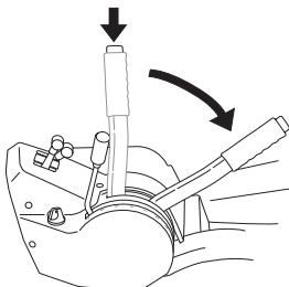
Этот рычаг можно также использовать для временного регулирования высоты резки, например на небольшом бугре на газоне.
