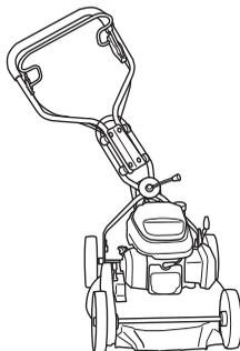
Руль можно также установить вертикально поворотом колес при помощи узла крепления на шасси
